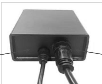
モーターケーブルプラグ（メス）を大きな丸いコネクタに挿入し、ノッチを回して押し、しっかりとねじ込みます。電源ソケットをオンにします。四角いソケットの間のLEDランプが緑色に点滅してから赤色に点灯します。
